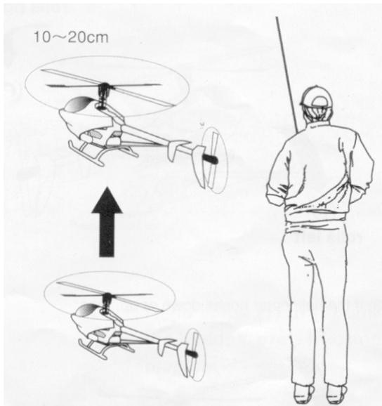
revise el movimiento izquierda /derecha y delante / detrás del plato cíclico, para asegurarse de que el rotor principal se mueve en la dirección que usted ordena. Mueva el stick ( mando ) que mueve el rotor de la cola para asegurarse de que la “ nariz “ del helicóptero gira en la dirección que usted desea.
