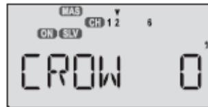
27 (Solo para 4WNG). Usando el menú de subtrims haga el ajuste fino de los neutros de flaps. Utilice la función E.P.A. para obtener la carrera de flaps que desee. Le sugerimos que use los brazos de servo más largos que tenga a fin de incrementar el mando de flaps.
