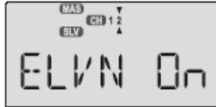
4 Pulse CURSOR RIGHT para acceder al menú de recorrido del elevador y verá como aparece una flecha encima del indicador del canal 2, indicando que es el canal MASTER y la cantidad de mezcla parpadeará. Una fecha debajo del canal, indicará que está siendo programado.
