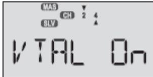
6 Ahora podemos ajustar la función del timón de dirección . Verifiquemos que la flecha este debajo del CH4, si no lo está, pulsamos CURSOR RIGHT para ir al mismo (Las flechas deben estar encima y debajo del canal 4) y podrá cambiar el recorrido mediante las teclas INC/DEC DATA. Un 50 % sería un buen valor para empezar,
