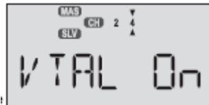
7 Ahora podremos ajustar la respuesta al mando en el canal 2 pulsando una vez CURSOR RIGHT. La flecha inferior debe señalar al Ch 2, y puede ajustar el recorrido usando INC/DEC DATA
