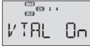
4 Pulse CURSOR RIGHT una vez para acceder al menú de ajuste del elevador. Una flecha aparecerá sobre el canal 2 indicando que en esta mezcla actúa como MASTER, otra debajo indicando que estamos programando el canal 2, y el indicador de porcentaje parpadeará. Coloque en stick en posición todo arriba y ambos elevadores deberían levantarse. Si el canal derecho bajase, pulse CLEAR para ir a 0 y programe el movimiento con signo contrario pulsando INC/DEC DATA hasta un valor del 50% aproximadamente.
