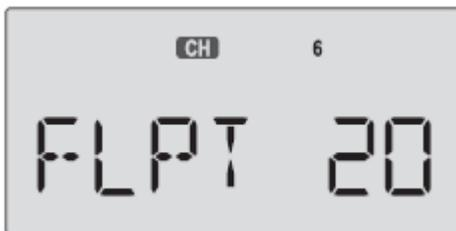
44 Si desea diferencial para sus alerones, puede fijarlo a través del menú de flaperones. Primeramente hay que reducir la cantidad de mando hacia abajo del alerón derecho. Pulse el RIGHT CURSOR, hasta que ambos triángulos parpadeen encima y debajo del número 1. Mantenga el stick hacia la izquierda y pulse DECREASE DATA hasta dejarlo entre un 50 y un 75%. Asegúrese de estar trabajando en el alerón DERECHO.
