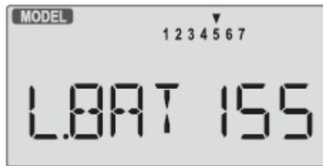
El tiempo de funcionamiento aparece aún a la derecha. Si Vd. pone a cero el tiempo de funcionamiento después de cada recarga, tendrá una idea muy aproximada de cuanto tiempo puede operar con seguridad.
