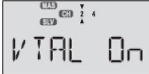
5 Si el que bajase fuese el elevador izquierdo al mandar arriba, cambie el sentido de giro pulsando CURSOR RIGHT para ir al canal 4 (la flecha inferior señala al CH.4), luego CLEAR para ir a 0 y fijar recorrido de signo contrario usando INC/DEC DATA. Hasta el mismo valor del Ch2.
