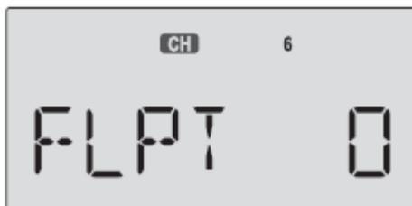
El alerón izquierdo es gobernado por el canal 6, y antes de invertir el sentido, debe fijar el canal 6 mediante la tecla RIGHT. Recuerde que al mover el stick hacia la derecha el alerón izquierdo debe BAJAR. Pulse la tecla UP o DOWN para acceder a la función FLAP TRIM y deje el porcentaje a 0 usando las teclas INCREASE/DECREASE DATA.
