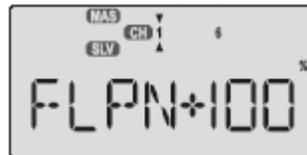
funcionase al revés, pulse CLEAR para ir a 0 y con las teclas INC/DEC DATA invierta el valor del recorrido del servo.
