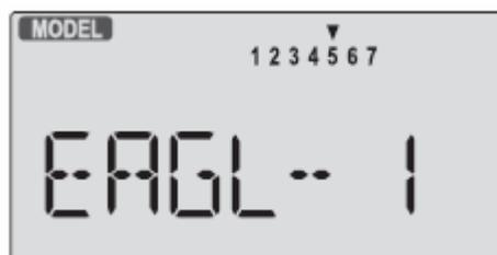
Apretando el botón START/STOP aparece la pantalla del cronómetro, en el que aparecen dos valores, el primero corresponde al tiempo de vuelo actual, el segundo al tiempo acumulado de funcionamiento del transmisor. Al apretar el botón start/stop pone el cronómetro en marcha, y pulsando
