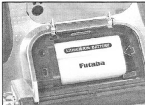
4. Coloque y presione la tapa de la batería hasta escuchar el "click" de cierre.
